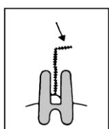
2 ワイヤーの先端を直角に曲げて下さい。その状態でポストから取り出します。
